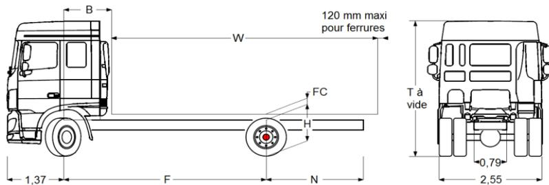
( FC ) Mini : 120 mm avec pneumatiques 315/60R22.5 et longerons 260 mm.
