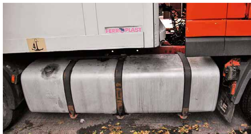
Топливный бак вмещает 870 литров, при благоприятной ситуации можно преодолеть около 3000 км без дозаправки
