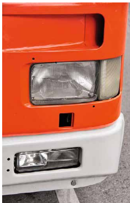
Передние световые приборы с ностальгичными рассеивателями гармонично вписаны в бампер, получивший ещё в те годы дополнительные аэродинамические каналы обтекатели, фары светят неплохо
