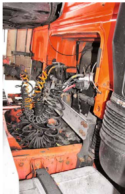
При подъёме кабины сцепные шланги останутся на месте, ЛКП, несмотря на возраст и пробег, пока неплохо сопротивляется коррозии
