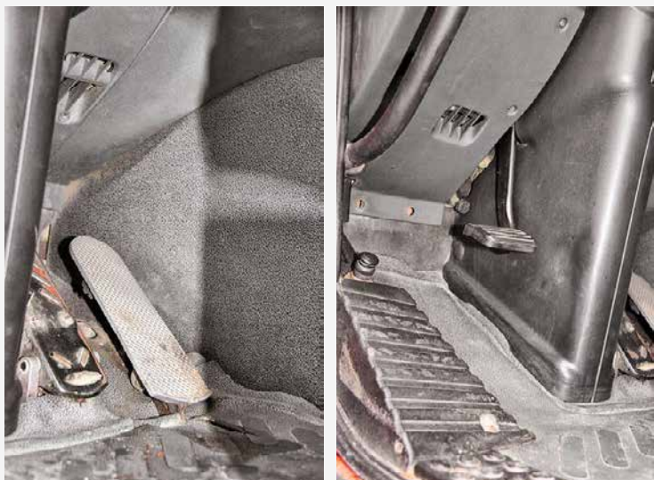
Педальный узел комбинированный. Акселератор и тормоз – напольные педали, педаль сцепления очень лёгкая – подвесная. Видна площадка для отдыха левой ноги, за которой притаилась «пуговка» горного тормоза
