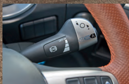
Управление моторным тормозом выведено на подрулевой рычажок...
