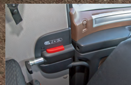
На дверях стоят ночные замки — стальные засовы с пружинными фиксаторами
