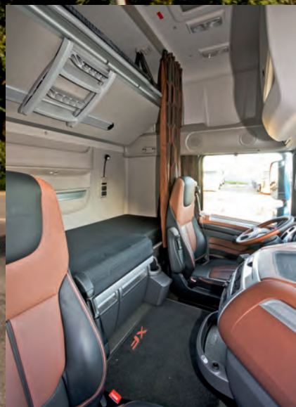
От небольшого моторного тоннеля до потолка — 2 м 10 см
